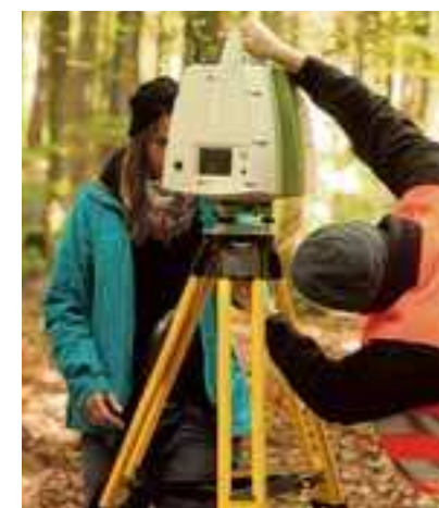
Das Gelände im Wald wird mit einem 3-D-Scanner genau vermessen.
