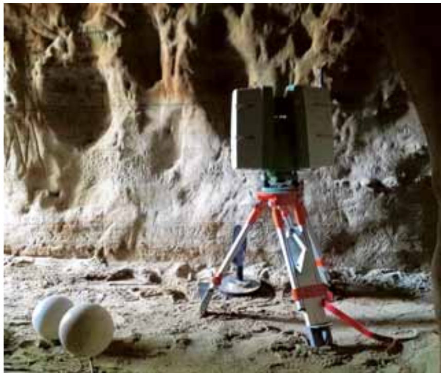
Der Kopf rotiert, die Oberflächen werden abgetastet, die Daten dazu gespeichert. Der 3-D-Laserscanner in Aktion.
