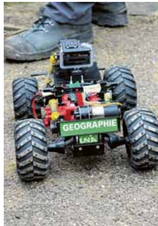
Kommt auch an die entlegensten Stellen, das ferngesteuerte Kamerafahrzeug.
